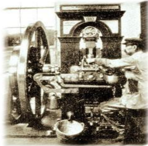
La primera máquina-herramienta fabricada en España: la prensa tipo Thonelier, construida por "La Maquinista Terrestre y Marítima" en 1863 para la Casa de la Moneda de Madrid. Fabricó las primeras pesetas, ahora desaparecidas.
