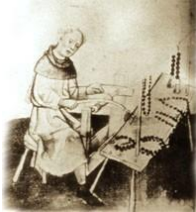
Grabado de torno accionado por arco (1435), principio de funcionamiento todavía en uso en algunos países.
