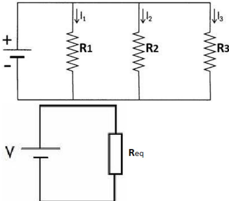
Se observa que: (1)  $V = V_1 = V_2 = V_3$
