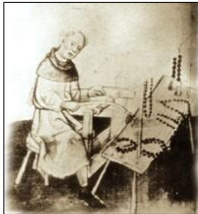
Grabado de torno accionado por arco (1435), principio de funcionamiento todavía en uso en algunos países.
